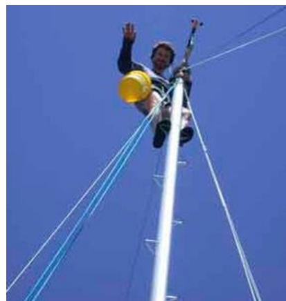
Degraus no mastro.
