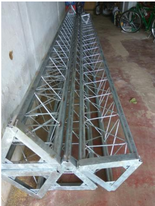
Módulos de torre construídos com tubos e barras redondas.
